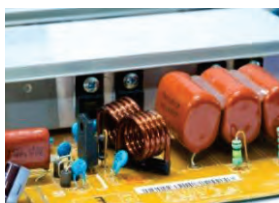
Air Core Inductor
